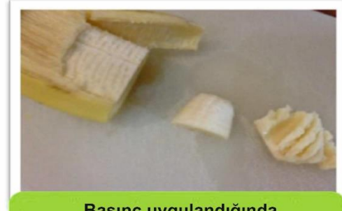
Basınç uygulandığında numune ezilir ve orijinal şekline geri dönmez
